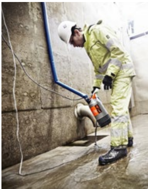
Pompt het water weg tot 1-2 mm. Bij plaatsing op een vlakke vloer: Hmax: 10,5 m en Qmax: 3,2 l/s
